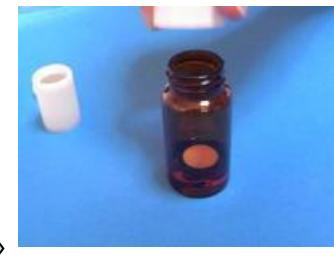
適当な大きさのビンや試験管に純水(蒸留水やイオン交換水)8mLを正確に入れておきます
