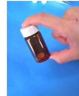
軽く振り混ぜた後30分以上放置して、捕集成分を水に抽出します
