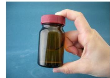
軽く振り混ぜた後30分以上放置して、捕集成分を水に抽出します
