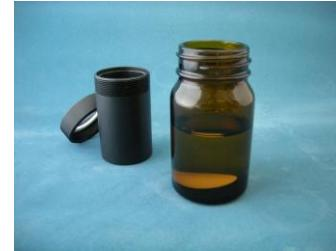
適当な大きさのビンや試験管に純水(蒸留水やイオン交換水)40mLを正確に入れておきます
